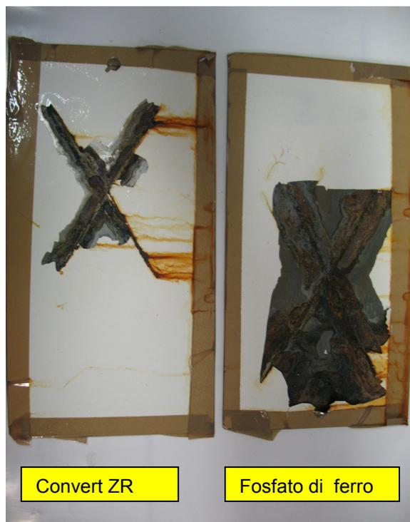
Soluzioni molto diluite di **CONVERT ZR** possono venire utilizzate per sigillare e ulteriormente passivare superfici precedentemente fosfatate ottenendo un compatto strato fosfo-zirconato.
