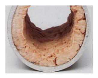
Scaricare l'acqua contenuta nell'impianto ed asportare il materiale più grossolano; introdurre una soluzione di **DESCALIT** al 10-20% (100-200 grammi di prodotto in un litro di acqua) e farla circolare sino a completa disincrostazione. Risciacquare abbondantemente e con cura sino a completa scomparsa di residui, verificare che l'acqua di risciacquo sia a pH perfettamente neutro.
