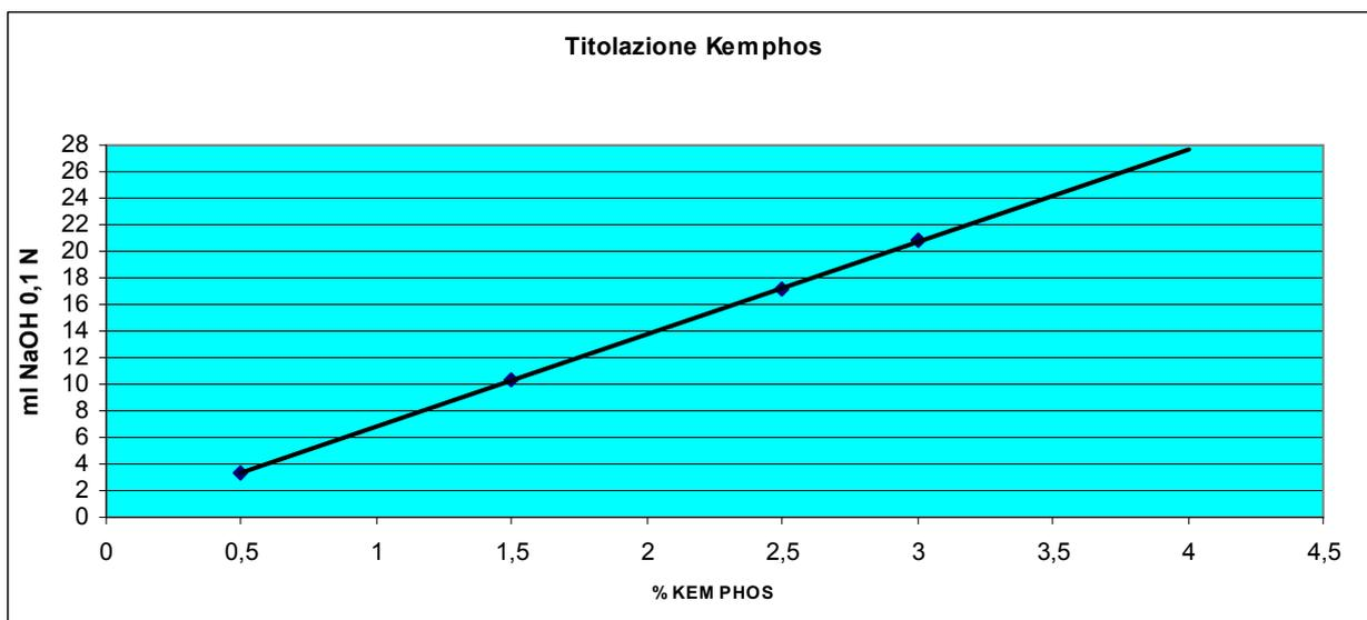
Prelevare 20 ml di soluzione e aggiungere 2 ÷ 3 gocce di indicatore. Titolare con sodio idrossido (NaOH) 0.1N annotando i ml impiegati. Ricavare dal grafico la concentrazione del KEMPHOS
