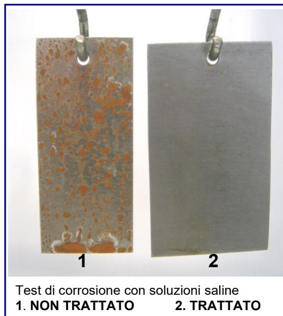
Test di corrosione con soluzioni saline
